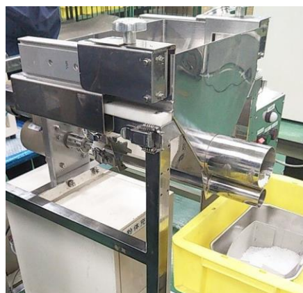
大小2本のスクリーンを使用するタイプの供給機です。 (オプション2軸式仕様)
